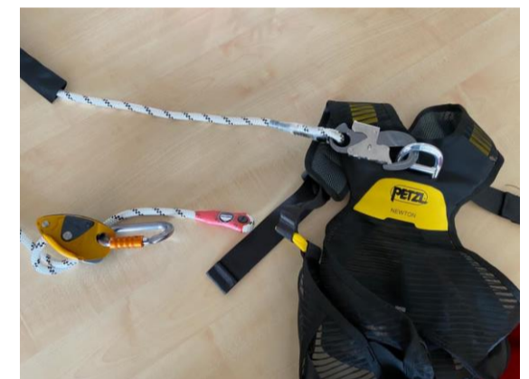
Foto 2 | wijze van bevestigen aan de achterzijde van het harnas
